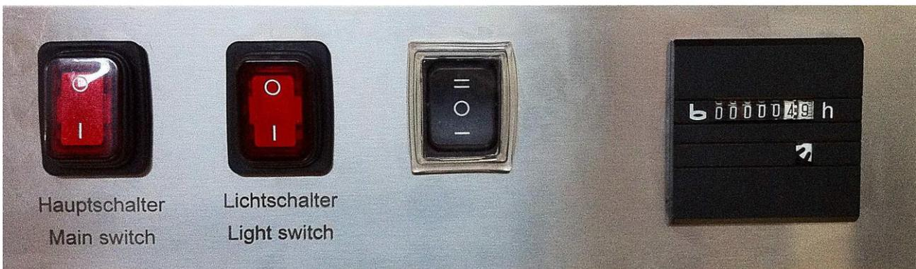
Über den eingebauten Betriebsstundenzähler kann die Laufzeit der Aktivkohle Filterpatrone überwacht werden.
