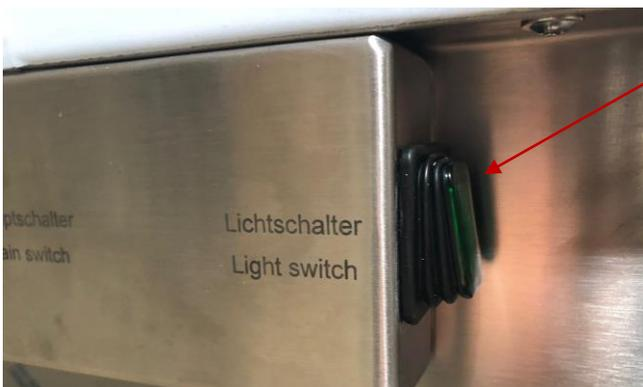
Durch einmalige Betätigung des Wippenschalters wird der Beleuchtungsaufbau eingeschaltet. Durch nochmaliges Betätigen kann die Leuchtstärke stufenlos eingestellt werden. Wird danach den Wippenschalter nochmals betätigt, schaltet sich die LED Beleuchtung aus.
