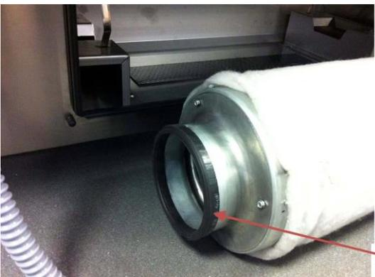
Bevor Sie die neue Filterpatrone einsetzen prüfen Sie ob die angebrachte Dichtung an der Patrone einwandfrei ist.
