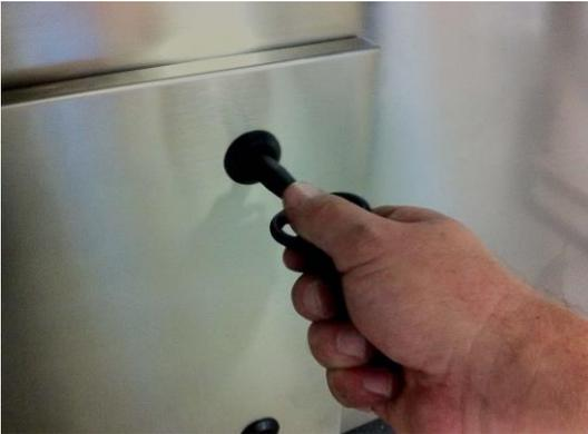
Öffnen Sie hierzu den Revision Deckel mit dem beiliegendem 4-kant Schlüssen und nehmen den Deckel komplett ab.
